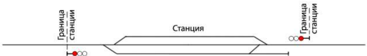
Рисунок 4.89 – Границы железнодорожной станции на однопутном участке
