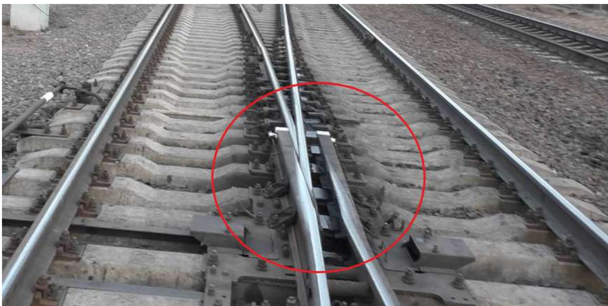
Рисунок 5.120 – Стрелочный перевод с подвижным сердечником стрелочной крестовины
