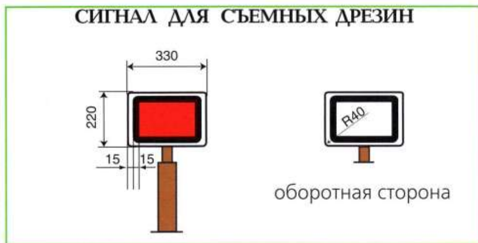
Рисунок 5.139 – Прямоугольный щит (сигнал для обозначения дрезин съемного типа)
