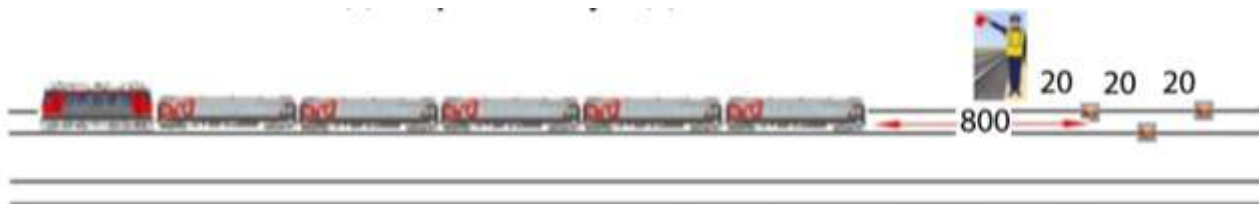
Рисунок 5.80 – Ограждение на перегоне пассажирского поезда при вынужденной остановке
