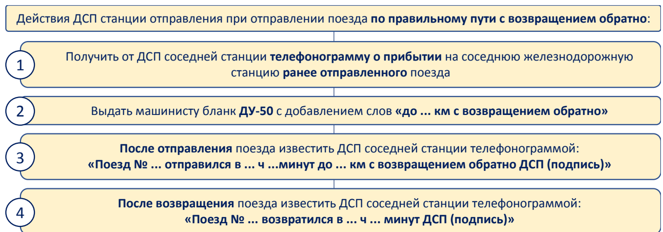
Рисунок 5.63 – Алгоритм действий дежурного по станции отправления при отправлении поезда по правильному железнодорожному пути с возвращением обратно
