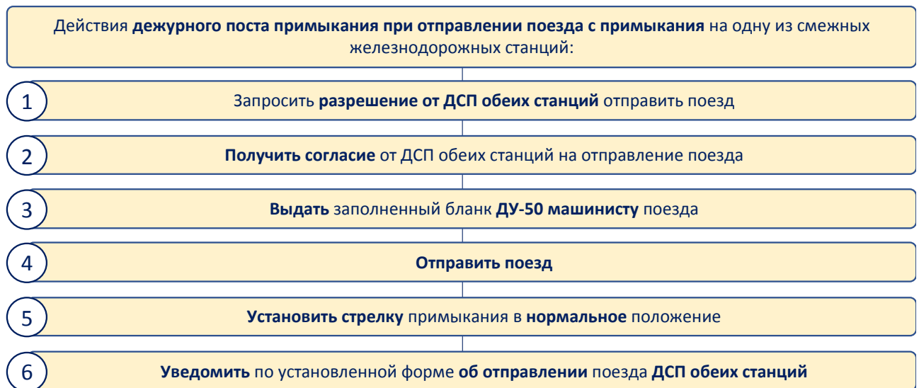
Рисунок 5.58 – Алгоритм действий дежурного путевого поста при отправлении поезда с примыкания на смежную железнодорожную станцию
