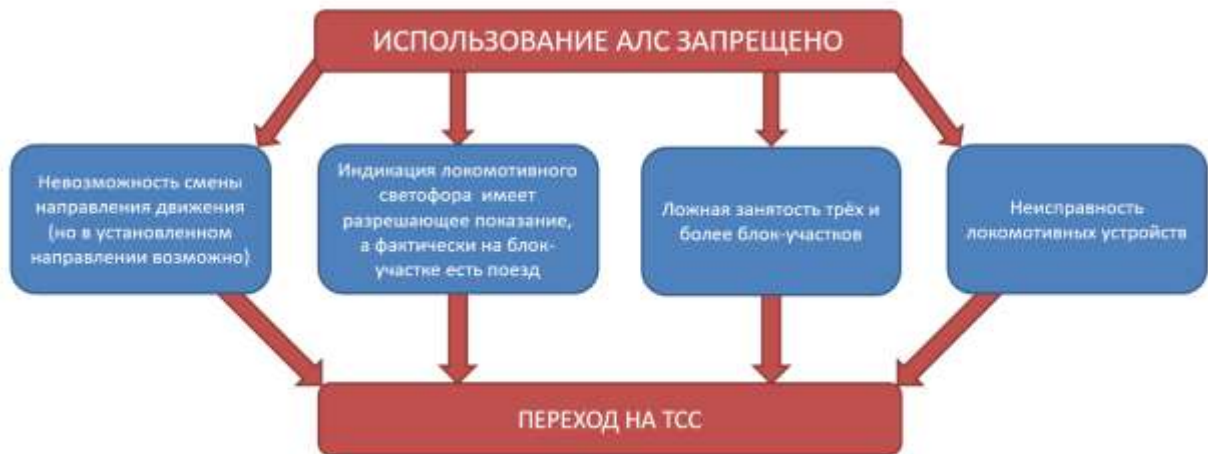
Рисунок 5.30 – Неисправности, при которых необходимо прекращать действие АЛС
