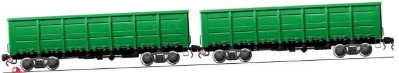
Рисунок 5.104 – Случай укладки тормозного башмака под крайний вагон
