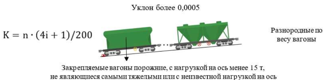
Рисунок 5.111 – Случай закрепления подвижного состава на уклонах более 0,0005, при котором норма рассчитывается по формуле 2
