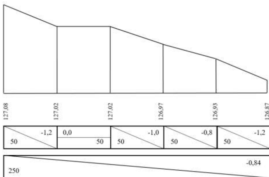
Рисунок 5.114 – Фрагмент продольного профиля железнодорожного пути
