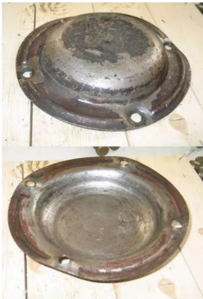
Рисунок 2.54 – Внешний вид неисправности буксового узла – деформация смотровой крышки
