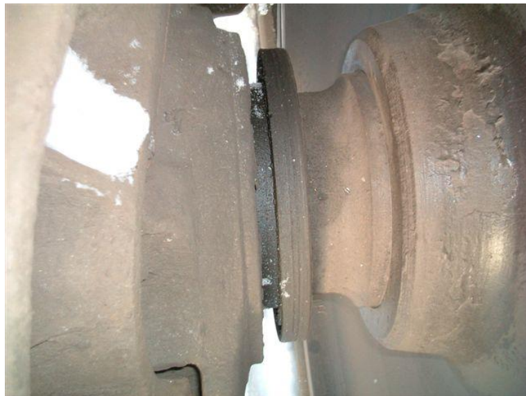
Рисунок 2.57 – Внешний вид неисправности буксового узла – сдвиг корпуса буксы
