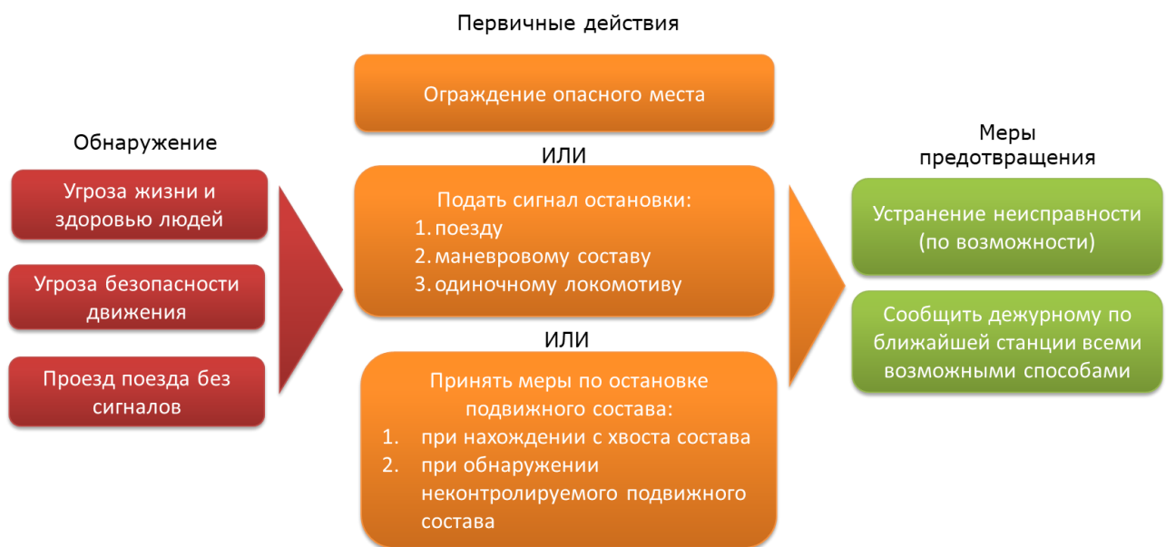
Рисунок 2.2 – Примерный порядок действий при угрозе жизни и здоровью людей или безопасности движения
