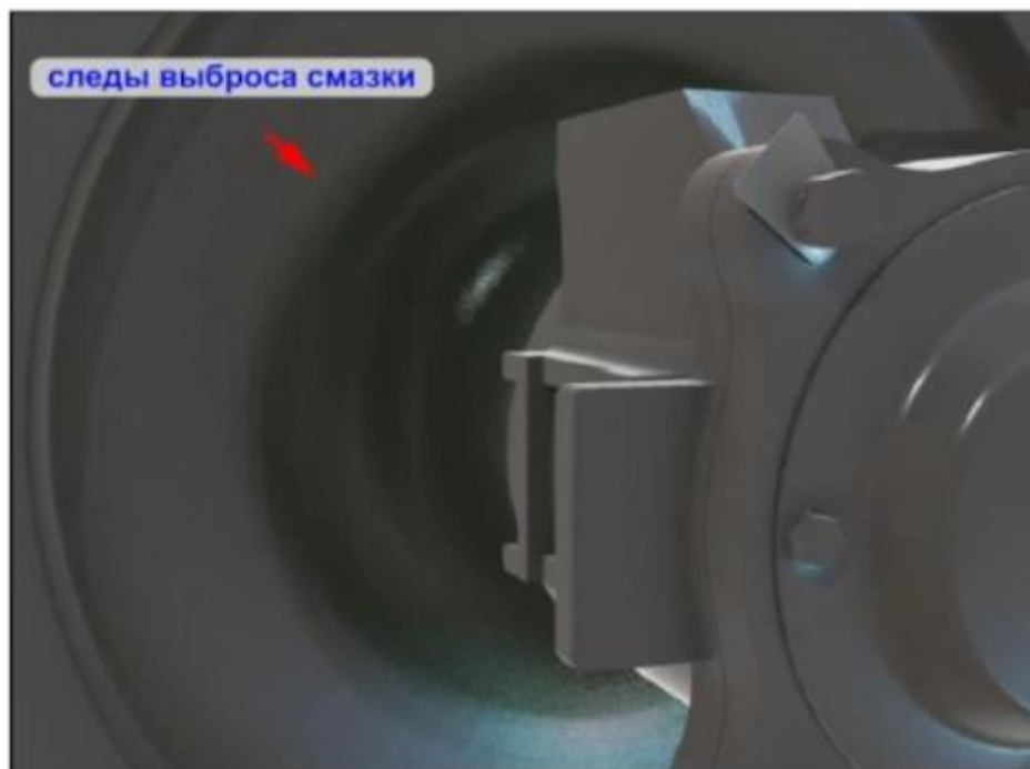
Рисунок 2.53 – Внешний вид неисправности буксового узла – выброс смазки на диск, обод, ступицу
