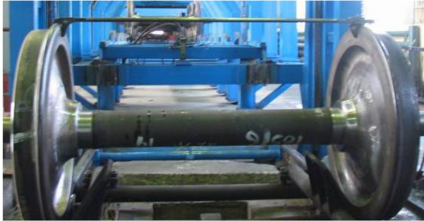
Рисунок 2.49 – Пример измерения расстояния между внутренними гранями колес
