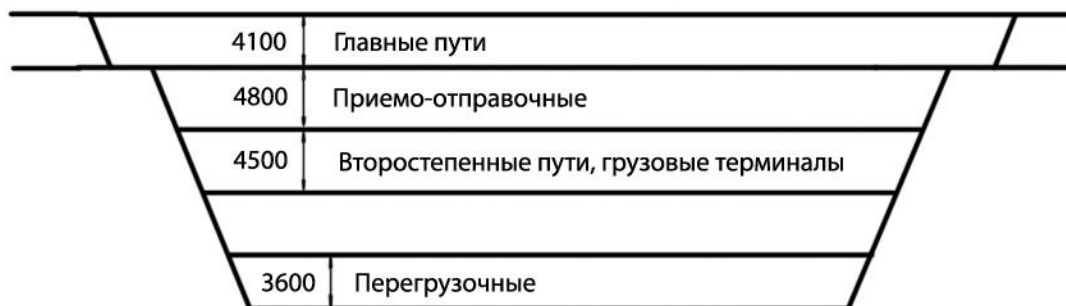
Рисунок 2.7 – Минимальные расстояния между осями железнодорожных путей
