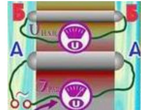
По проводнику А - А протекает переменный рабочий ток ( $J_{\text{раб.}}$ ). Вокруг этого проводника существует электромагнитное поле (окрашено в красный цвет).
