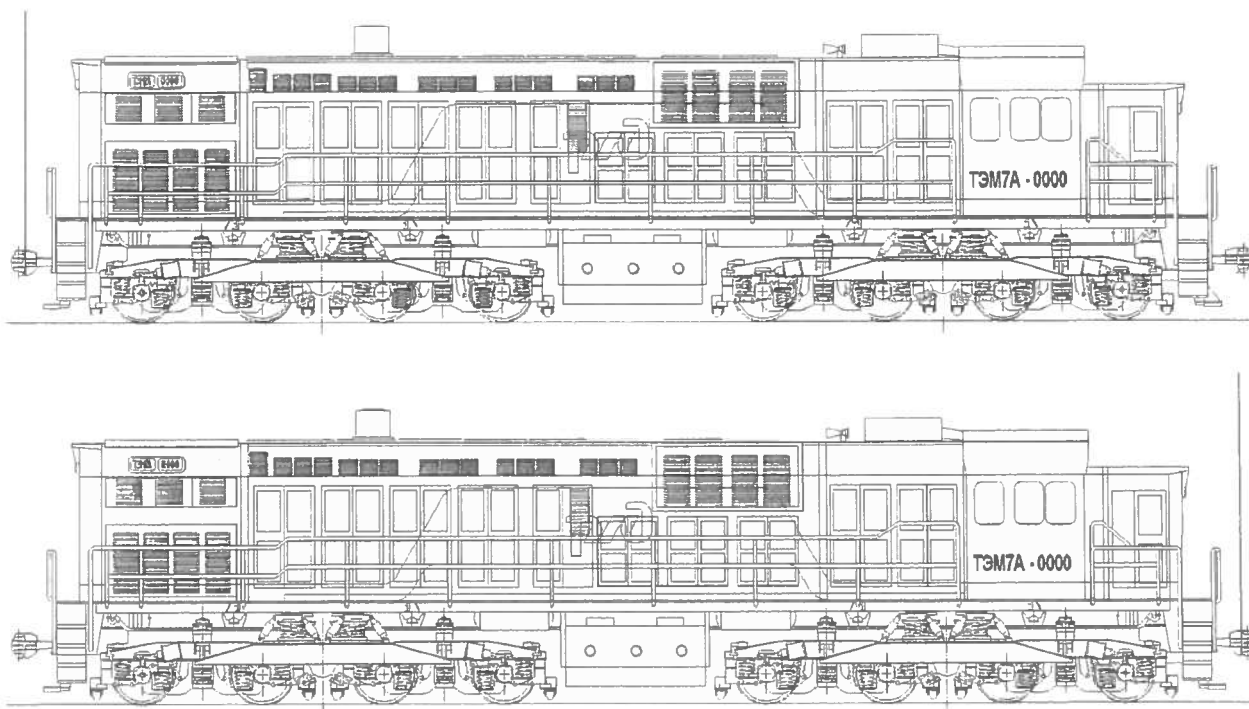
Рисунок 84 Схема строповки при аварийном подъеме тепловоза за автосцепку
